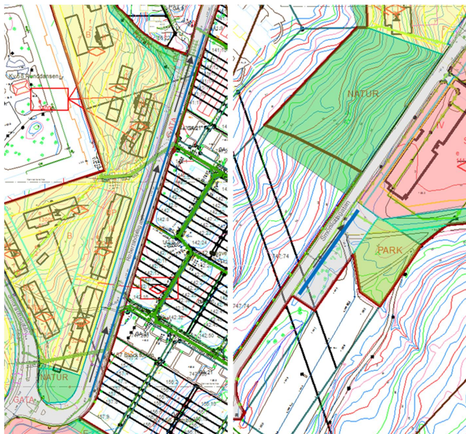
Figur 17. Förslag på dagvattenlösning för delområde 6. Helderaget blått streck illustrerar makadamdike.
